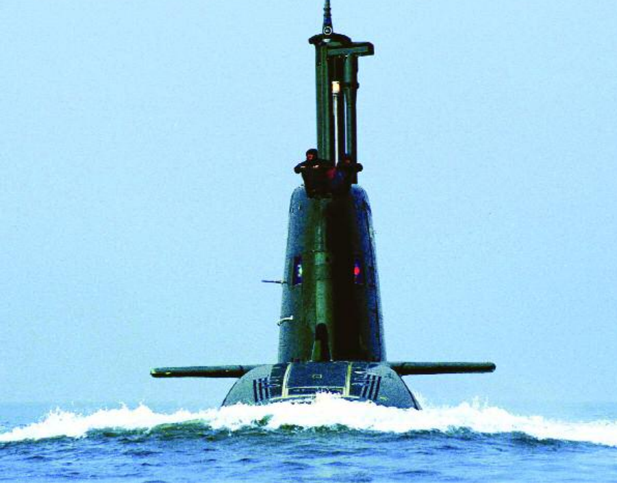
İsrail için Almanya'da üretilen aynı adlı ilk Dolphin (Yunus) sınıfı denizaltı. (Fotoğraf: HDW)
